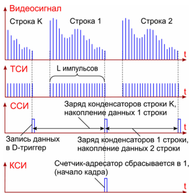
Рис. 6. Временные диаграммы сигналов синхронизации схемы развертки изображения
