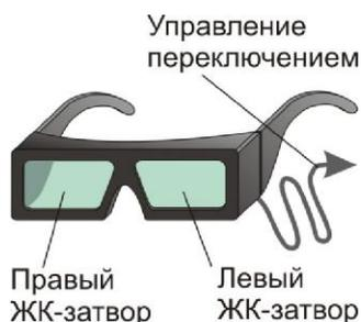
Рис.3. Жидкокристаллические стереоочки
