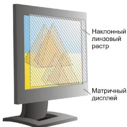
Рис.8. Автостереоскопический дисплей
