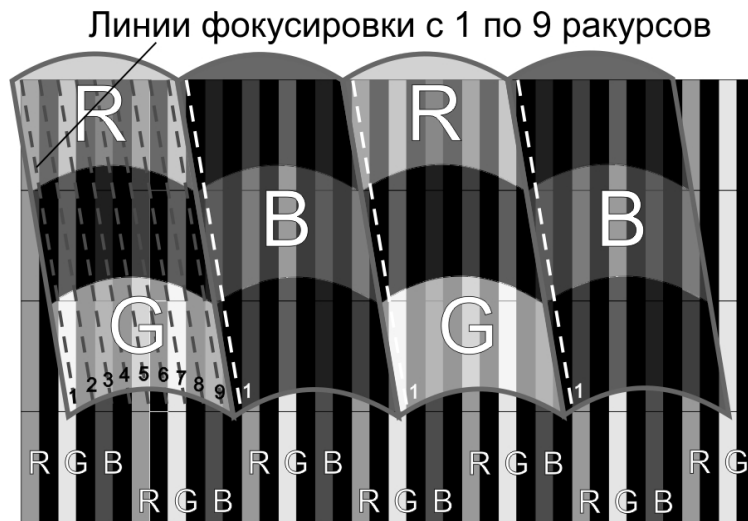
Рис. 7. Формирование изображений растром с уменьшенным углом наклона линз
